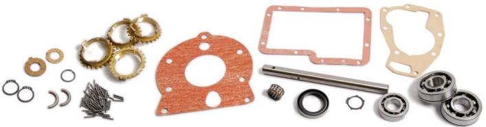
IF YOU'VE HAD TO STRIP YOUR GEARBOX, USE OUR GEARBOX OVERHAUL KIT WHEN RE-BUILDING. PHOTO SHOWS OVERHAUL KIT FOR SINGLE-RAIL TYPE GEARBOX.
